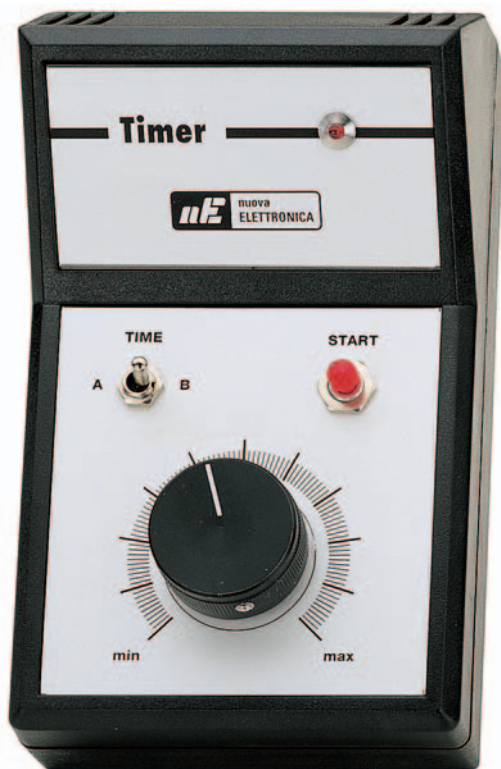
Figure 491: Aspect extérieur des deux montages (temporisateurs 1 et 2). La LED, l'inverseur S1 et le poussoir P1, ainsi que le bouton du potentiomètre R3, sont en face avant. Les fils entrent (alimentation) et sortent (commande relais) par le panneau arrière.
