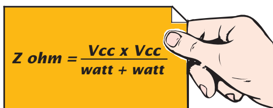
Figure 390 : L'impédance de collecteur d'un transistor peut être calculée avec cette formule. Vcc est la tension maximale que le transistor peut accepter et W la puissance HF maximale qu'il peut fournir. Le tableau 20 indique les valeurs moyennes d'impédances de collecteur et de base en fonction de la puissance maximale en W.
