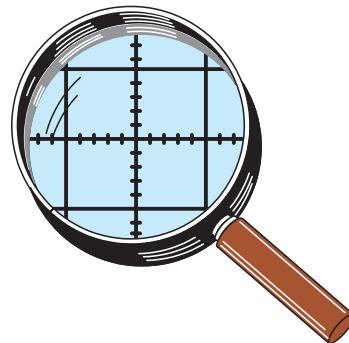
Figure 11 : La croix graduée au centre de l'écran permet d'évaluer les décimales d'une tension. En effet, chaque carreau vertical est divisé en cinq parties (4 petits traits plus les deux limites du carreau). En fonction du réglage du bouton V/div chaque partie a une valeur de tension indiquée par le Tableau 1.
